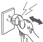
→如果电源线、电源插头损坏，为避免危险，必须由本公司指定的维修人员来更换。
