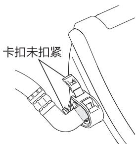
4. 一边握住进水软管，一边轻轻转动快速卡扣，确认转动时没有障碍。
