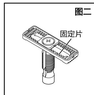
③ 上方施工螺栓在本体固定板上的初步定位。
