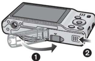
**1** 朝箭头指示的方向滑动释放开关，打开记忆卡 / 电池盖。
