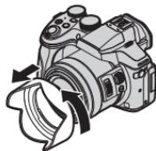
② 使镜头遮光罩上的安装标记 (A) 对准相机底部标记 (B) 的略微偏右位置，然后固定镜头遮光罩
