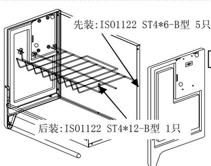
⑤右侧板安装螺丝固定
