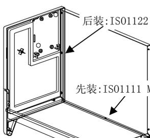
②左侧板和背板安装螺丝固定
