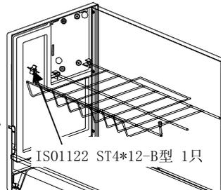
③左侧板和隔栏板安装螺丝固定
