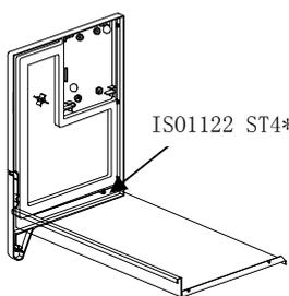
①左侧板和底板安装螺丝固定
