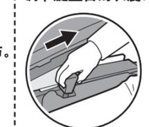
拉动腿置台滑动杆，同时脚掌下踩，可以调节腿置台的长度。
