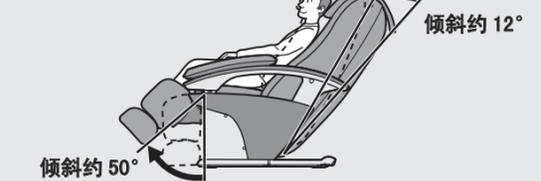
• 若按摩椅倾斜角度超过按摩位置的角度，它将不会自动返回正确的按摩位置。
