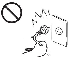
如果拉扯电源线有可能损坏电源线导致触电·短路·火灾。
