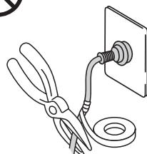
放置重物、加热、拉扯所产生的破损，是火灾及触电发生的原因。
