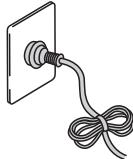
请不要割伤、加工、强力弯曲、拉扯、上压重物或用尼龙绑带及铁丝捆绑。损坏后继续使用有可能导致触电·短路·引起火灾。
