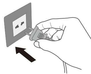
■ 因为异味感应器以插入电源插头时的空气洁净度作为基准, 建议当室内空气洁净时(如没有烟味时)插入电源插头。(异味感应器的基准会根据室内的空气洁净度自动更新。)
