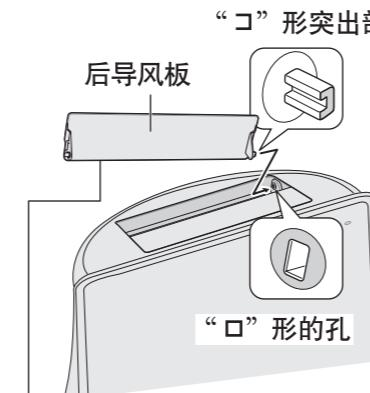
请勿错误安装前导风板和后导风板。
