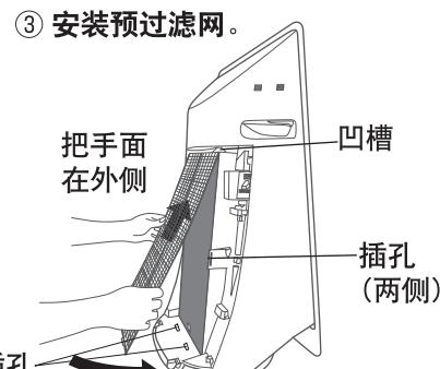
先把预过滤网上面两个凸出位插凹槽，再将下面两个凸出位插入下部插孔，最后将中间两边凸出位卡入两侧插孔。
