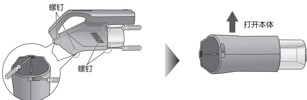
2 拉出接插端子，按下中间的卡扣打开接插端子，取下电池组件
