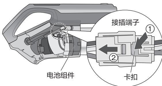
3 如图用一字螺丝刀等工具打开支架，再旋开 4 个螺钉，打开塑料盖，取出电池
