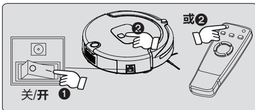
1. 打开电源开关，长按“自动清扫”键或遥控器电源键，此时吸尘器处于待机模式。
