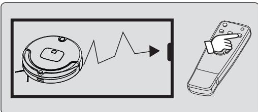
4. 按遥控器上的“回充”按键，吸尘器自动寻找充电座充电。
