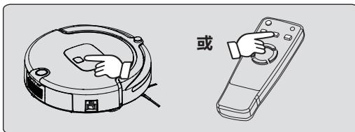
2. 待机模式下，再按“自动清扫”键或遥控器“自动清扫”键，吸尘器开始自动清扫。
