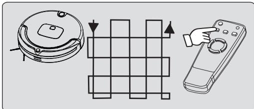
3. 待机模式下，再按遥控器上的“局部清扫”键，吸尘器开始在特定区域(约1平方米范围)内，进行局部清扫。
