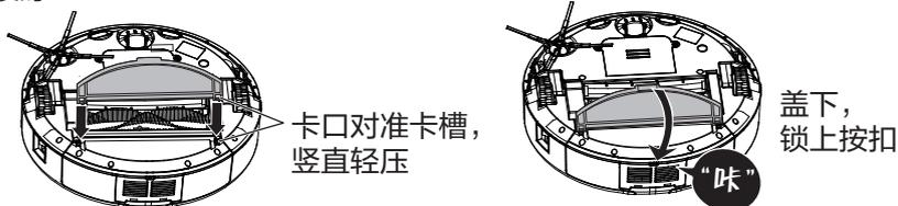
■ 脱卸时：与安装相反的顺序，先打开按扣，打开至竖直后，再小心向上拉出即可
