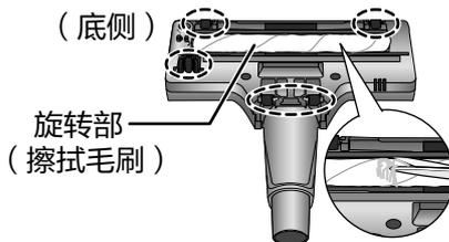
● 如图用剪刀剪断缠绕的垃圾
