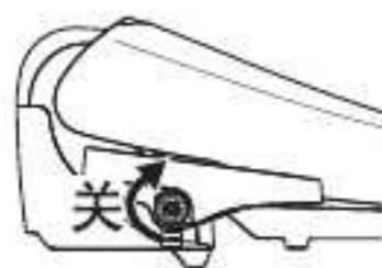
没有确实拧紧的话会引起漏水。
