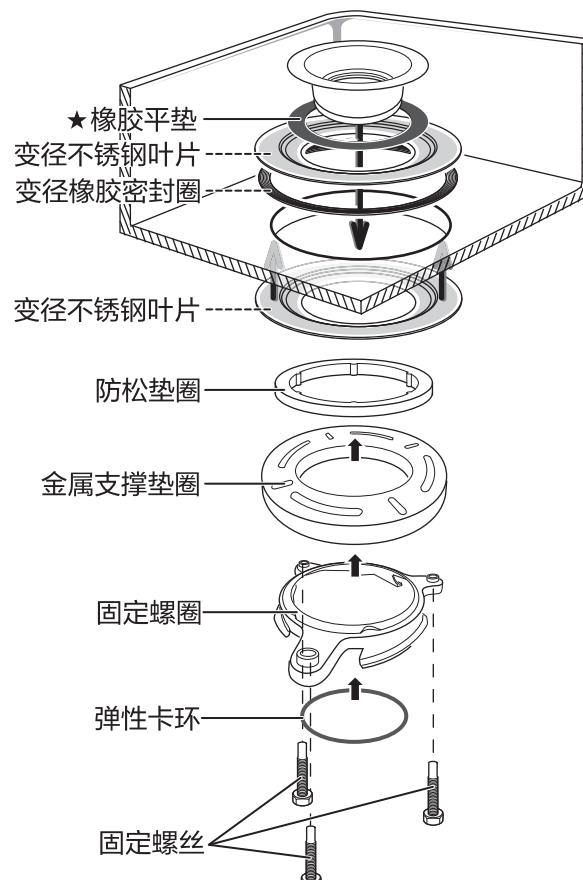
★放置橡胶平垫时，有凸筋的一面朝下
