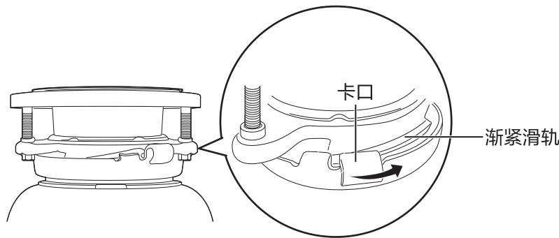
③ 如图用螺丝刀插入锁紧环孔眼, 逆时针用力转动, 将卡口滑至渐紧滑轨的尽头, 本体安装完成
