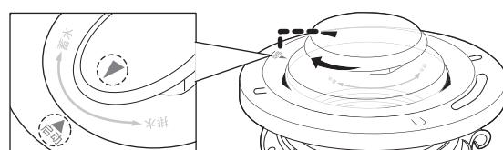
⑤ 取出磁控开关（并确保手柄不再转动），再拧紧其背部的螺丝，调试完成
