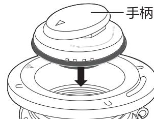
④ 启动后，仅旋转手柄，将上面的“▼”转至对准本体（落水口处）上的“▲”
