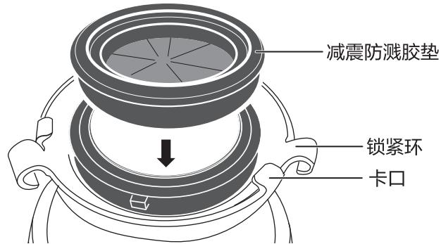
② 托起本体, 抬起锁紧环 (勿倾斜) 使卡口 (3 处) 卡入固定螺圈上的渐紧滑轨 (3 处)
