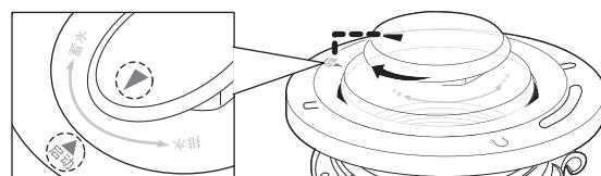
⑤ 取出磁控开关（并确保手柄不再转动），再拧紧其背部的螺丝，调试完成
