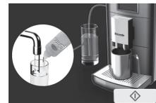
4 将清水加入玻璃杯然后按下
