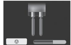
• 如牛奶表面高于喷嘴位置，可能导致牛奶从排水器冲调。如遇此情况，将排水器向上拉至最高位置。如情况继续，请即从牛奶包装拉出管并重新插入。
