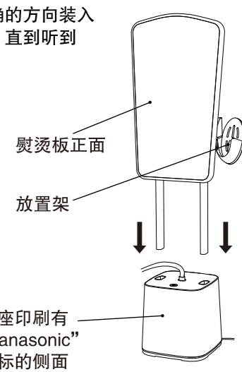
8. 将衣架固定架如图按正确的方向装入熨烫板顶部的接口。
