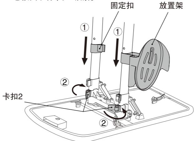
5. 将伸缩杆平放，然后图示将卡扣1锁紧。
