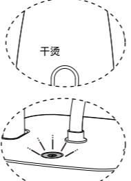
3. 按下电源开关，电源指示灯点亮，同时熨烫头部的“干烫”指示灯开始闪烁。
