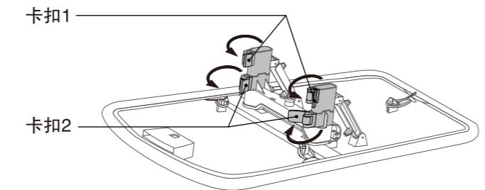
4. ①按图示将两根伸缩杆分别插入熨衣板A/B背面的伸缩杆接口中。注意伸缩杆插入的正确方向并将伸缩杆确实插到底。
