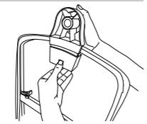
2. 松开熨烫板背面下端伸缩杆接口的卡扣1，将熨烫板调整为水平状态，并重新锁紧卡扣1，之后按压伸缩按钮，调节熨衣板至合适的高度。
