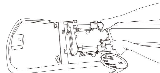
7. 将伸缩杆下端如图按正确的方向装入底座上的伸缩杆插口中，直到听到“咔”的声音。
