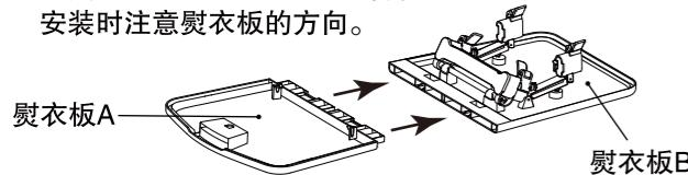
2. 将组装后的熨衣板A/B居中放置在平摊开的熨烫布上，先将熨烫布的线扣挂扣在熨衣板A/B的上部扣位，确认熨烫布已将熨衣板A/B完全包裹后，再收紧熨烫布的拉绳，最后将收紧的拉绳缠绕在熨衣板A/B的下部扣位并在其中间位置卡紧。
