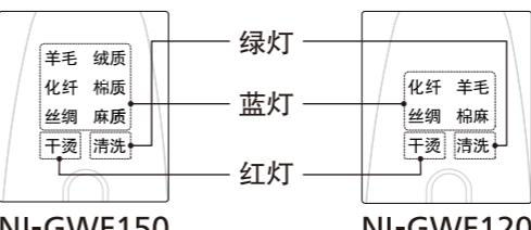
在切换档位时，功能指示灯亮灯的顺序为循环点亮。即按压一次档位切换按钮仅切换一次档位，如需切换到其他档位，请多次按压档位切换按钮切换到所需要的档位。此外，在切换档位时，“清洗”档位不会被选择，“清洗”档位的使用方法详见第14页《清洗功能》。
