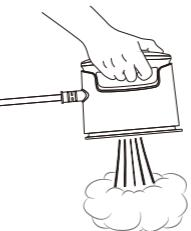
6. 等待约 1 分钟，蒸汽会变弱直至停止，蒸汽档位自动切换为“干烫”，将熨烫头部放回放置架。
