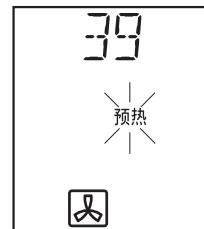
预热结束后，微波炉会蜂鸣，显示窗显示“预热完”。
