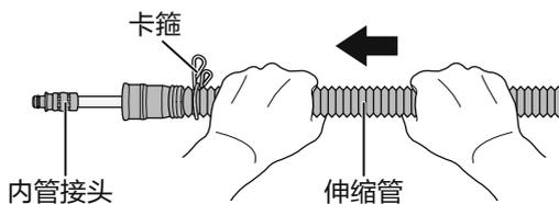
②. 将内管的接头插入机体，再将卡扣卡在连接处。
