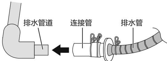
②. 再将连接管上外侧的卡箍移到端部, 将其牢牢固定。
