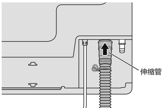
④. 卡箍上移卡在连接处（伸缩管端部第一个凹部），并将其尾部转向一侧。
