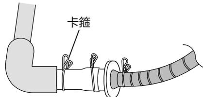
**防臭塞辅助型** (事先装好的排水管道直径为 40 mm、50 mm)
