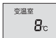
显示库内实际温度
