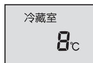
显示库内实际温度
