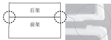
拆下突起，将前架里侧抬起后向前拉出。
