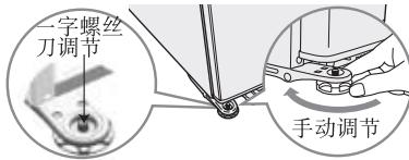
如果左右两个门不互相平齐，根据箭头方向调整较低一侧的调节脚，调节左右两门高度至水平状态。
