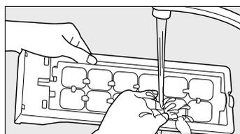
请勿用海绵等材质的清洁工具清洗制冰盒。（否则，可能出现划痕，导致冰块无法剥离，从而引发故障。）
