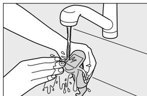
④ 从盖子的内侧边缘取下胶垫后，用水清洗胶垫。
