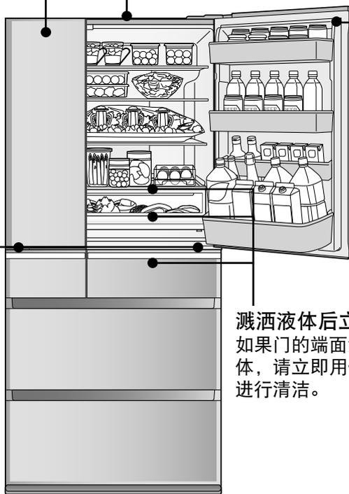
用柔软的湿布擦拭门封条后，如果仍有残余水分，请用干布擦净。（如果门封条上残留污垢，将容易对其造成损伤，导致冷气泄漏。）
