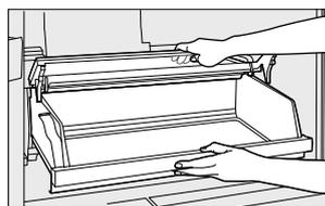
在抬起储物盒门的状态下，将储物盒的后部稍微抬起，沿冰箱内的轨道安装。
