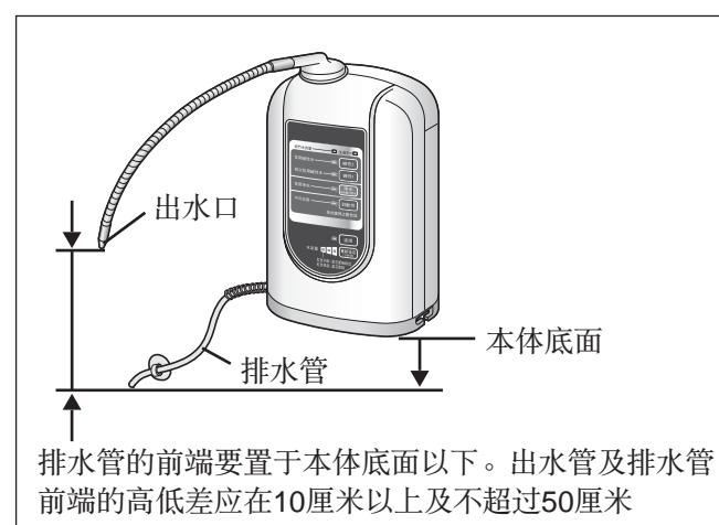
排水管的前端要置于本体底面以下。出水管及排水管前端的高低差应在10厘米以上及不超过50厘米
