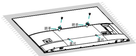
5. 将附件袋中的2个垫块固定在图示位置，然后再按照壁挂安装说明进行安装操作。
