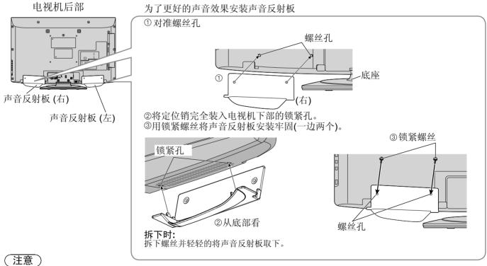
当您抬起电视机时确保声音反射板已经拆下。
