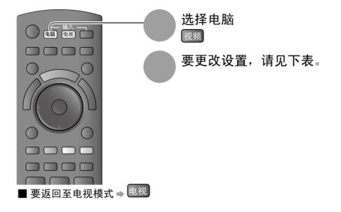
复电 ■电脑菜单设定(根据需要变更) 设视 菜单 项目 调节 配置 (选项) 定机 红增益 调整亮红区域的白平衡 高 冬 绿增益 调整亮绿区域的白平衡 级 像 电 蓝增益 调整亮蓝区域的白平衡 脑 菜 伽马 .0. .5 设 单 定 复位为默认 按确定键重置为默认设置 设定 切换为宽屏幕观看 ●V A 像素 输入分辨率 像素 ●根据信号不同,选项会改变。 时钟 如果出现干扰,则设定为最低电平。 调整水平位置  $\bigcirc$ О 水平位置 设 电 定 脑 调整垂直位置 设 菜 С ()定 垂直位置 С 单 消除闪烁和失真 时钟相位 ● 如果出现干扰,则设定为最低电平 ●时钟调整完成后调节 电脑同步信号种类(水平和垂直信号/绿信号) ●水平和垂直信号:来自电脑的水平和垂直信号(最常见的同步格式) ●绿信号 :来自电脑的绿同步信号(如果有的话) 同步 复位为默认 按确定键可复位为默认设定 设定
