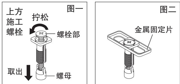
2.将金属固定片套入上方施工螺栓，再拧上螺母。（图二）
