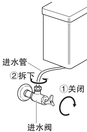
② 将进水软管上的分流水阀安装在进水阀上
