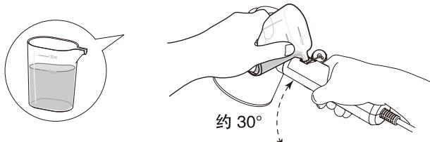
2. 在倾斜状态下关闭注水口盖，关闭时注意注水口盖装入的方向。
