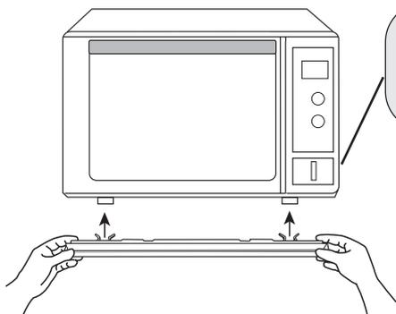
每次使用完与蒸气有关功能时，必须将装饰板里的结露水清除并及时清洗。清洗后应及时安装回炉脚处。
