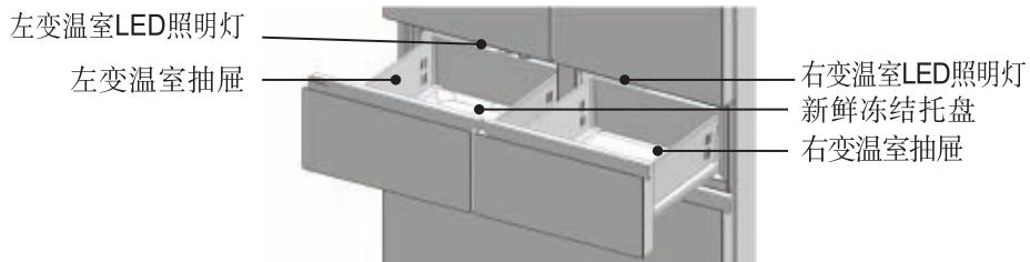
左变温室（右变温室）的设定温度范围为7℃ ~ -25℃，可根据储存食品的要求，进行温度设置。
